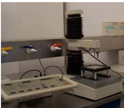
**Figura 15. Texturómetro TA-TX2**
