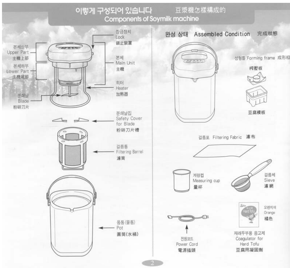
Figura 6. Partes del equipo soymilk-machine
