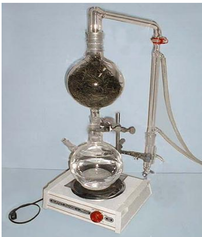
Fig. 9. Sistema de extracción por arrastre de vapor
