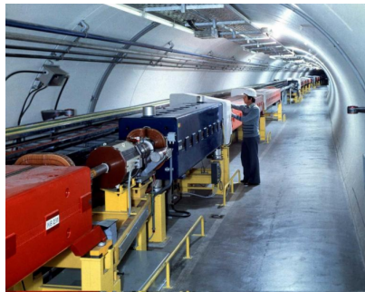
(d) The Super Proton Synchrotron pipe. Hadrons reach an energy of 450 GeV
