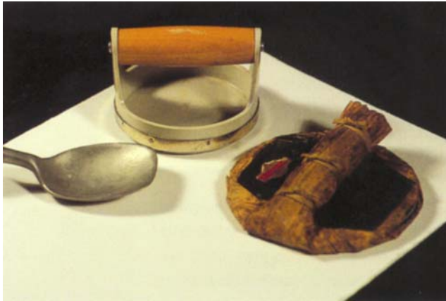
Herramientas para impresión manual: cuchara y dos tipos de baren japonés
