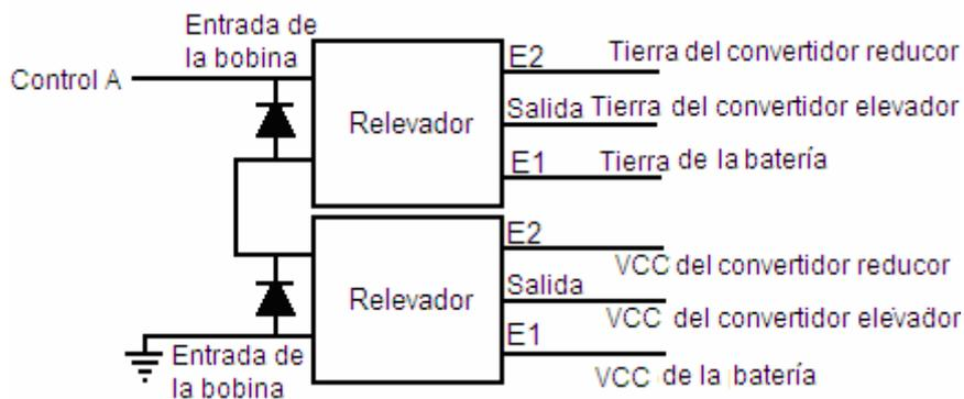
Figura 6.8 Esquema de la segunda serie de interruptores
