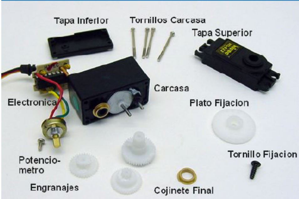
Fig. 9.10: Partes de un servomotor [26]
