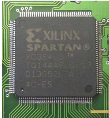
FIGURA 8.2 – Circuito integrado FPGA Spartan ® fabricado por Xilinx ® .
