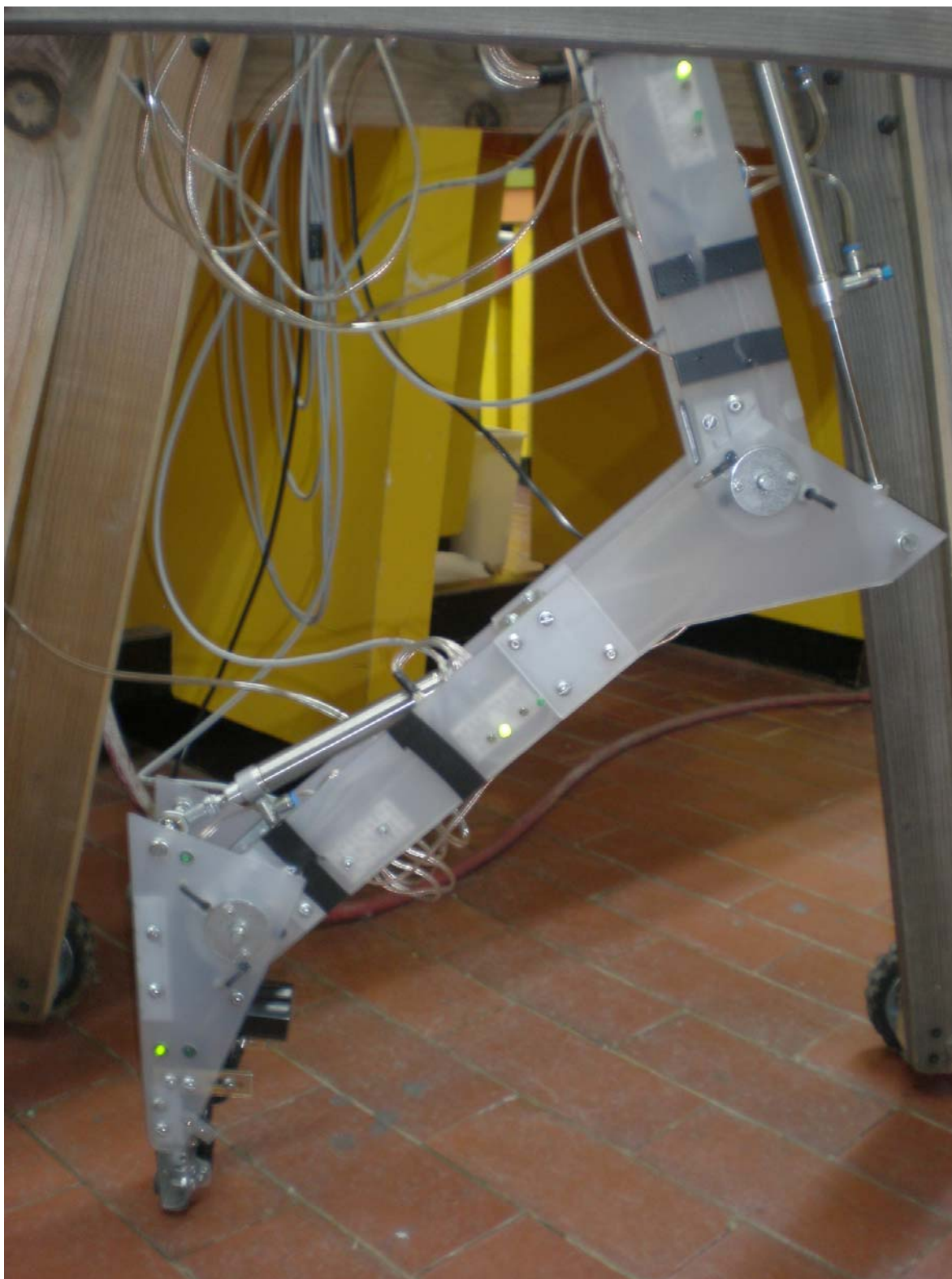
FIGURA 7.15d – Flexión de rodilla y flexión plantar del pie en el prototipo real.
