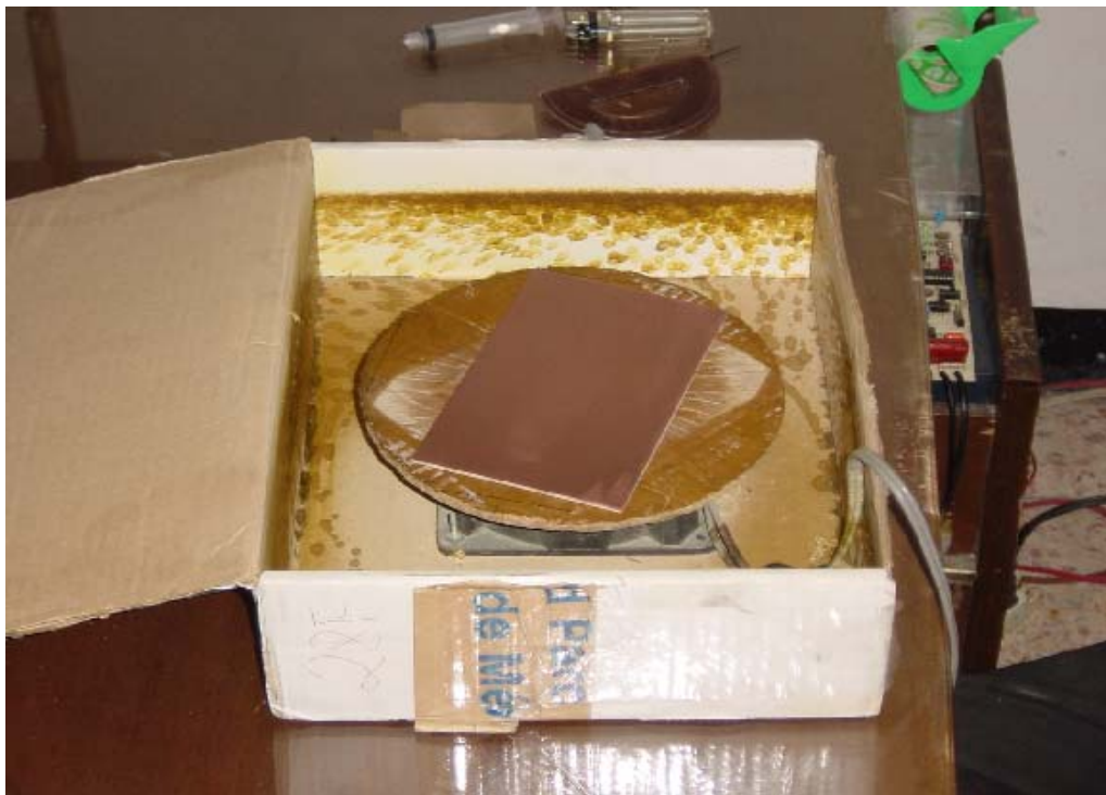
La centrifugadora, utilizada para el secado al aplicar la resina.
