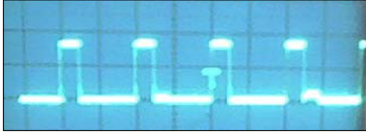
Figura 6.10 Foto de la respuesta del PWM que entrega el Microcontrolador a 180 grados.
