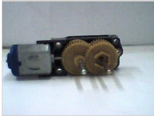
Figura 2 – 3. Vista transversal del motor con los engranes.
