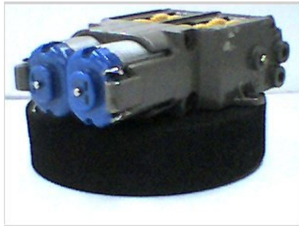
Figura 2 – 4 Motores ensamblados con los engranes, reducción 203:1.
