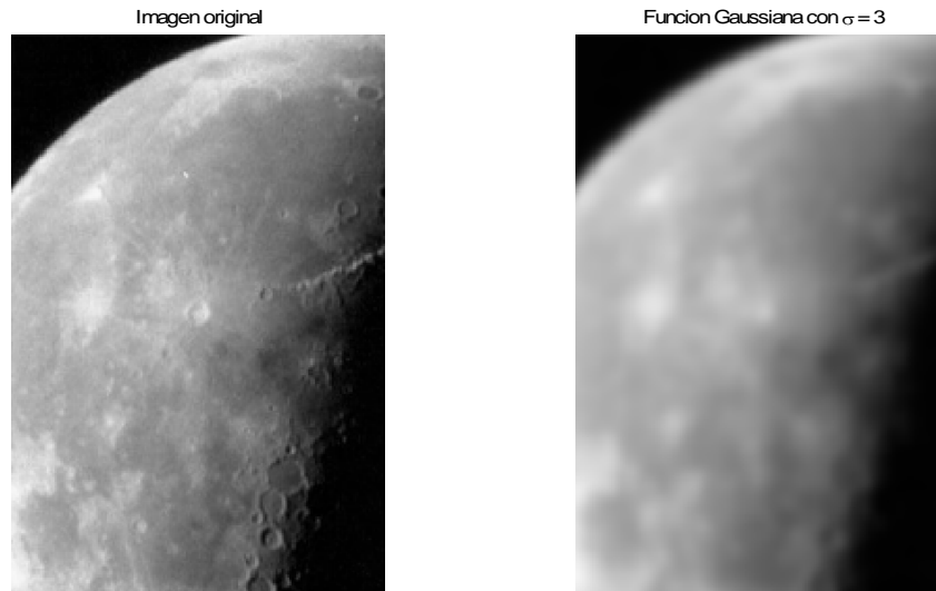
Figura 2.4 Convolución imagen original (izq.) con una función Gaussiana con \sigma = 3 . (Imagen obtenida de MATLAB).
