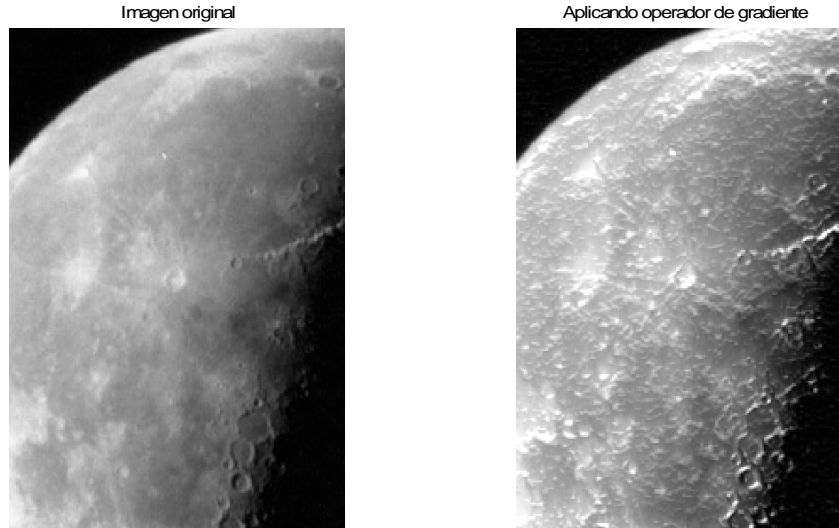
Figura 2.3 Muestra del operador de gradiente utilizando el operador Sobel. (Imagen obtenida de MATLAB)
