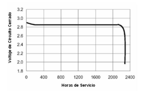
Figura 9.2 Comportamiento de la Corriente de Descarga (Li) [DUR01].
