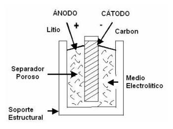
Figura 9.1 Componentes de una Batería [CHI01].
