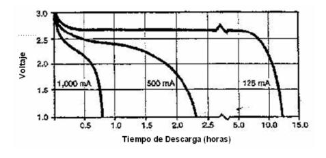
Figura 9.4 Comportamiento de la Corriente de Descarga (Litio-Ion) [DUR01].
