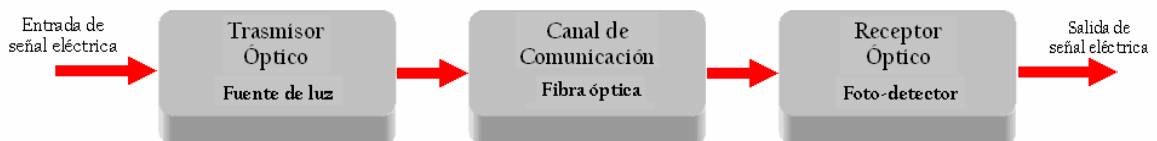
Figura 2.1 Esquema de un sistema de comunicación óptico general.
