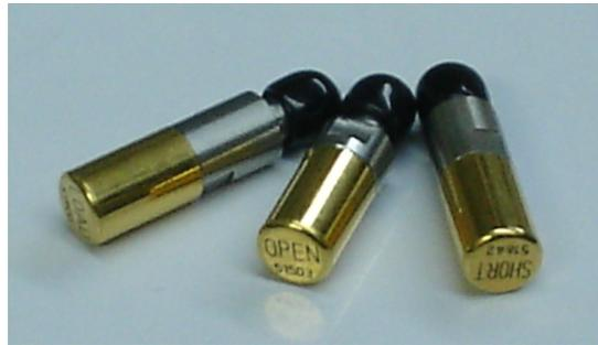
**Figura 6.6. Calibradores del analizador de red**
