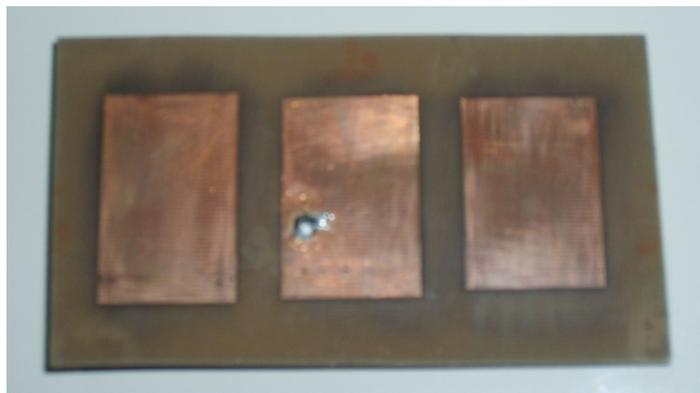
**Figura 6.1. Fotografía de la antena yagi ya construida.**
