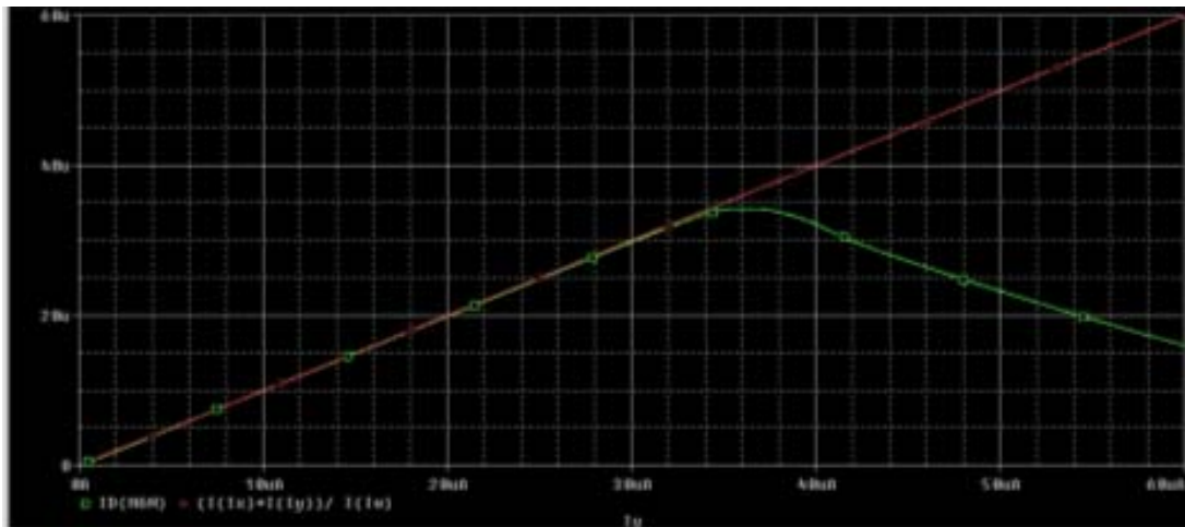
Figura 4.7. Respuesta final multiplicador/divisor ( M_{6N} ) comparada con la teórica, rango dinámico mayor a 30 \mu\text{A} con 1\text{V} en el nodo 1.
