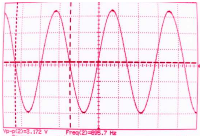
Figura 5.82 Ganancia máxima de la señal de salida en el primer rizo de la banda de paso.
