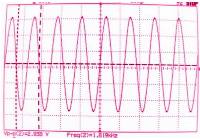
Figura 5.78 Ganancia de la señal de salida en f_{c2} .
