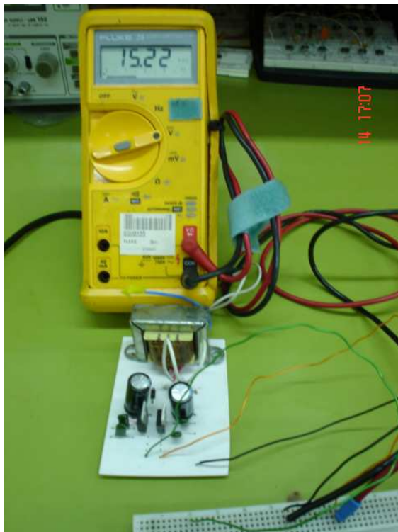
Figura 4.3 Voltaje de salida de la terminal positiva.
