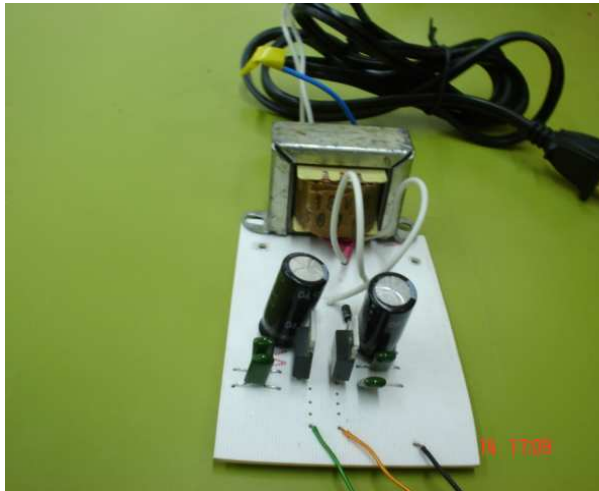
Figura 4.2 (a) Fuente de alimentación implementada.
