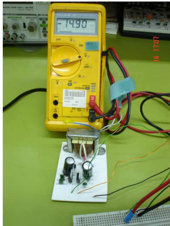
Figura 4.4 Voltaje de salida de la Terminal negativa.
