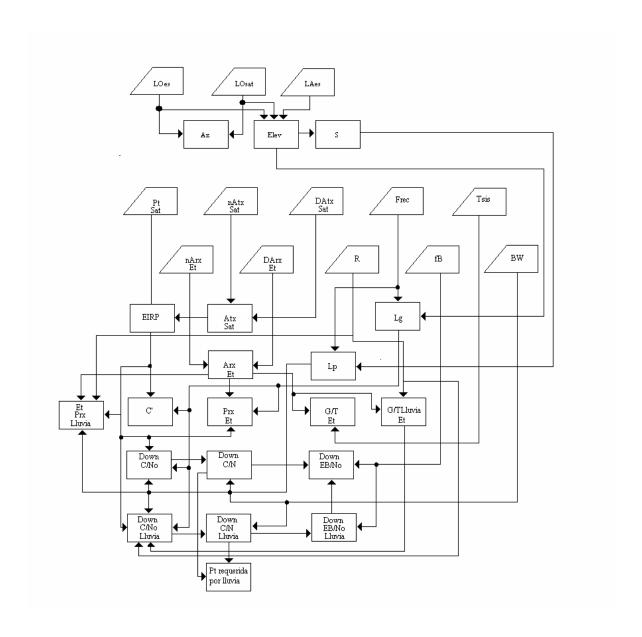
Figura 1-B Algoritmo de la eficiencia total del sistema.
