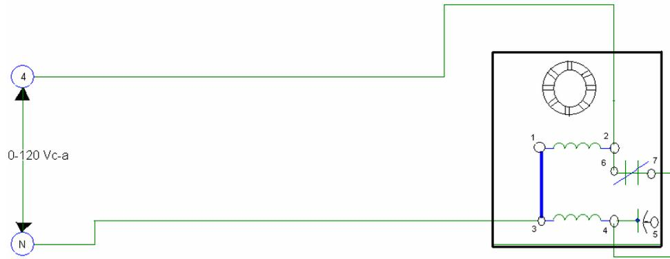
Figura 3. Circuito motor arranque capacitivo.
