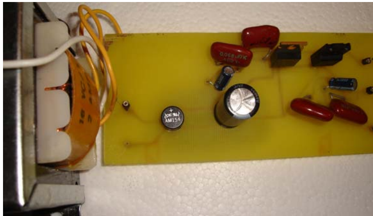
Figura E.3 Placa de alimentación y transformador
