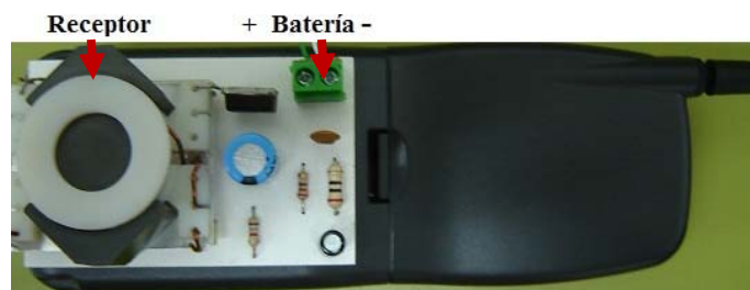
Figura C.1 Teléfono celular con circuito receptor montado en la parte posterior
