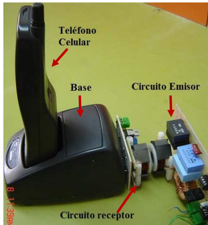
Figura 6. 28 Teléfono celular y base cerca del circuito emisor de energía
