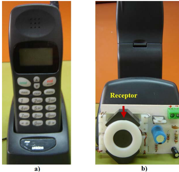
Figura 6. 26 (a) Teléfono celular con base. (b) Parte posterior con circuito receptor de energía.
