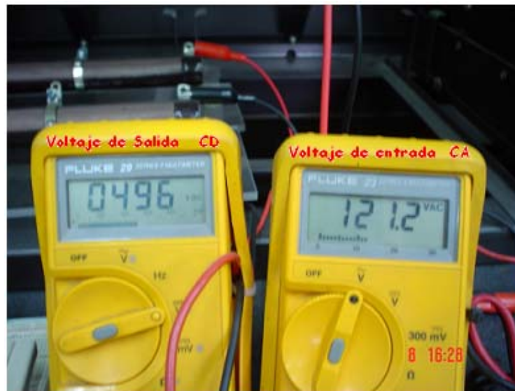
Figura 4.27 Voltaje de entrada y salida
