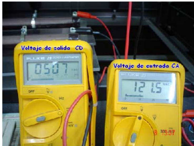
Figura 4.40 Voltaje de entrada y salida.
