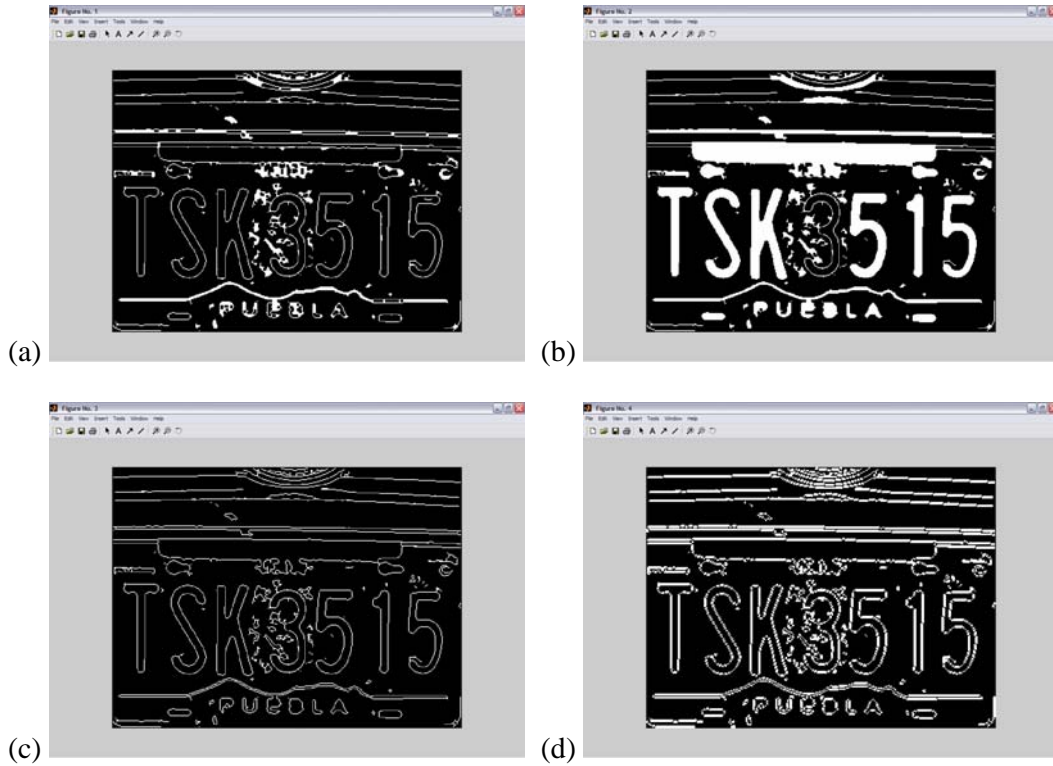
Figura 3.7. Procesamiento Morfológico: (a) Operador “close”. (b) Operador “fill”. (c) Operador remove. (d) Operador “thicken”.
