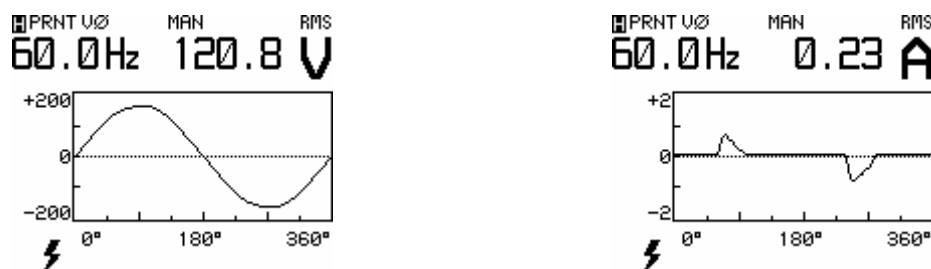
Fig. 6.10 Voltaje y corriente de entrada del balastro electrónico ISB.
