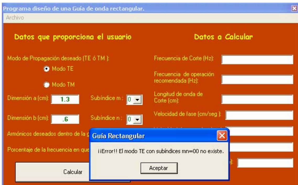
Figura 6.3-3. Mensaje de error para el modo TE de la interfaz del software.
