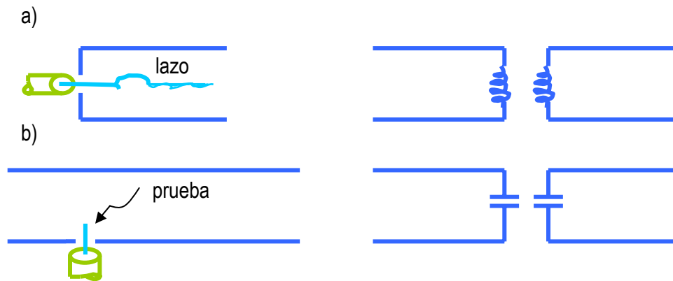
Figura 4.3-1. Métodos de excitación y su circuitos equivalente con lazo: a) con lazo, b) con punta de prueba.
