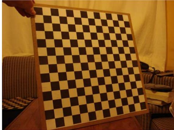
Figura 3.2 Patrón de calibración utilizado
