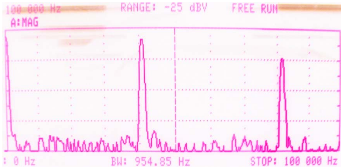
Figura 6.17 Espectro de magnitud de alta frecuencia de la corriente en una de las líneas
