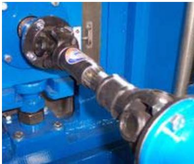
Fig. 2.1 Flecha Cardan con Junta universal.
