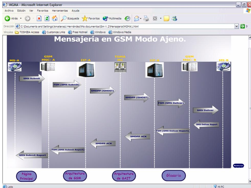
Figura 7.35 Imagen final de la trama de mensajería en GSM modo ajeno.
