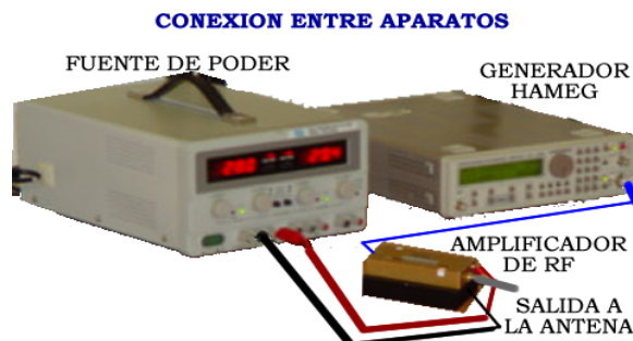
Figura 5.4 Interconexión de equipos.
