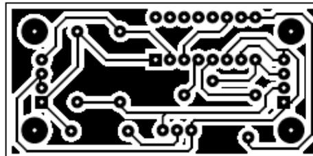
Capa inferior de la tarjeta de acondicionamiento de la galga
