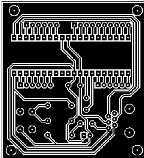
Capa inferior de la tarjeta de monitoreo y calibración
