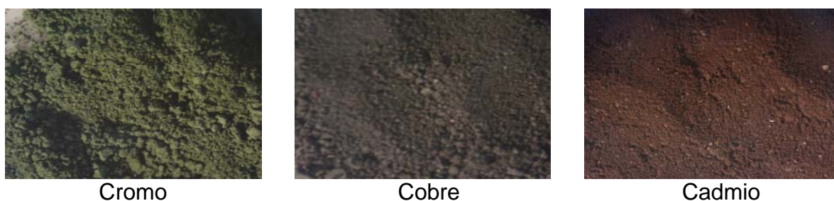
Figura 6.6. Aspecto de los lodos calcinados
