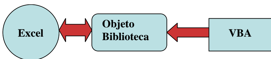
Figura 3.5 VBA se comunica con la biblioteca de objetos de Excel (Tomada de Jacobson, R. 2002).
