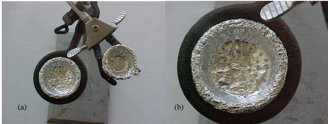
Figura 27. Distribuidores de aire. (a) Un distribuidor para cada tubo. (b) Acercamiento que muestra los orificios ubicados uniformemente sobre el distribuidor.
