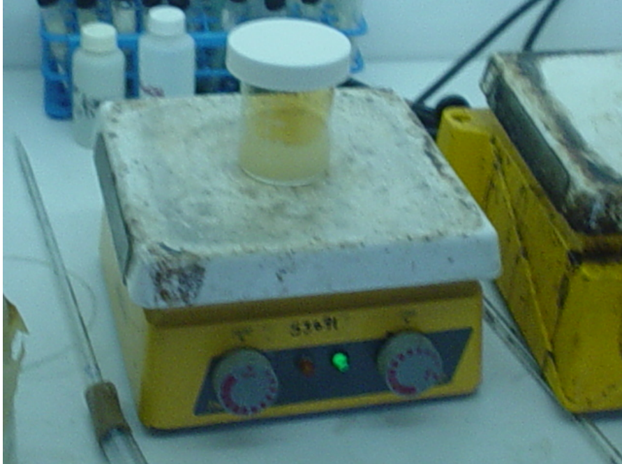
FOTOGRAFIA 43. Disolución de metal usando ácido nítrico y calentamiento.
