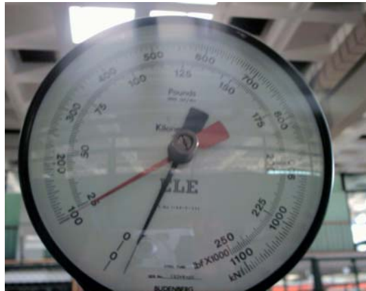
FOTOGRAFÍA 30 Indicador de Resistencia a la compresión, Pb a 10% 105
