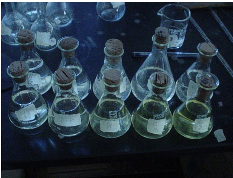
FOTOGRAFÍA 45. Elaboración de soluciones patrón para el espectrofotómetro.
