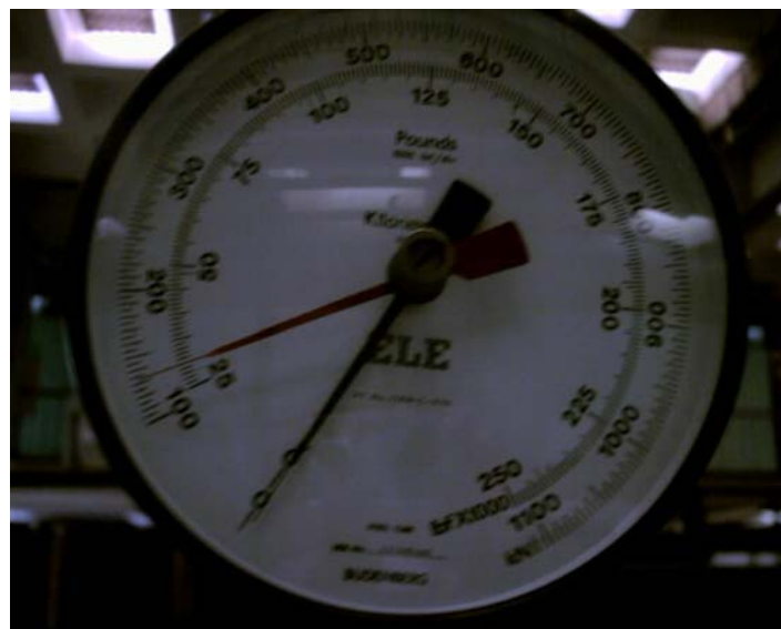
FOTOGRAFÍA 20 Indicador de Resistencia a la compresión, Ni a 3% 125 KN
