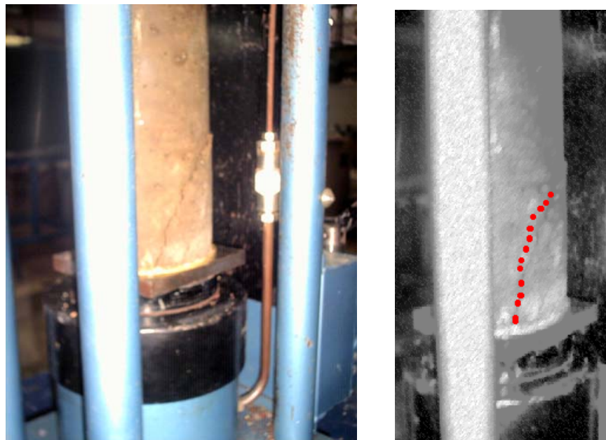
FOTOGRAFIA 17. Níquel a 1%, Resistencia ala compresión 150 KN
