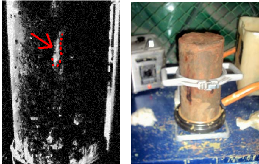
FOTOGRAFIA 21. Niquel a 5%, Resistencia a la compresión 110 KN.
