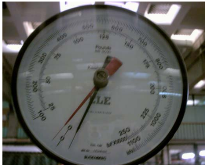
FOTOGRAFIA 16. Indicador de Resistencia a la compresión, Cr a 5% 25 KN
