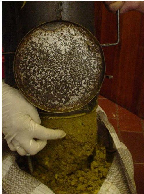
FOTOGRAFIA 8. PROBETA CON 10% DE CROMO (NO FUNCIONO)
