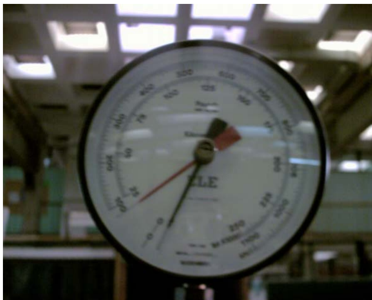
FOTOGRAFÍA 24. Indicador de Resistencia a la compresión, Ni a 10% 80 KN
