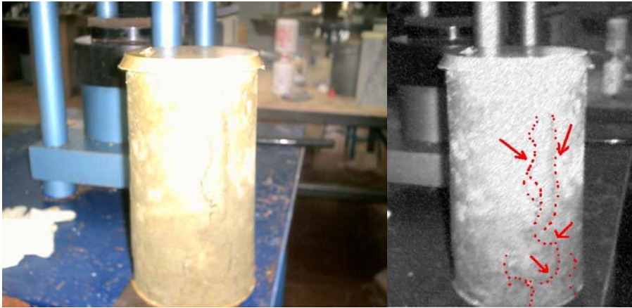
FOTOGRAFÍA 11. Cromo a 1% Resistencia 80 KN
