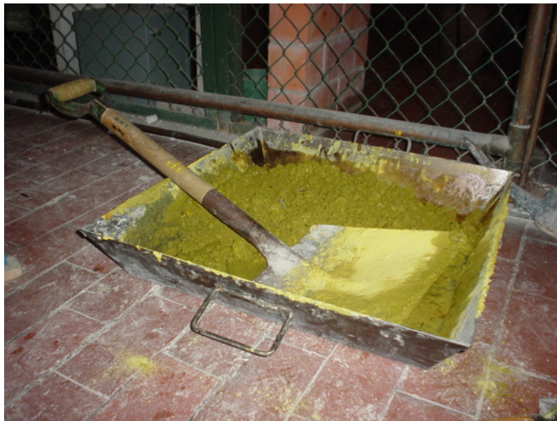
FOTOGRAFIA 4. Mezcla de elementos para conformar concreto con cromo.
