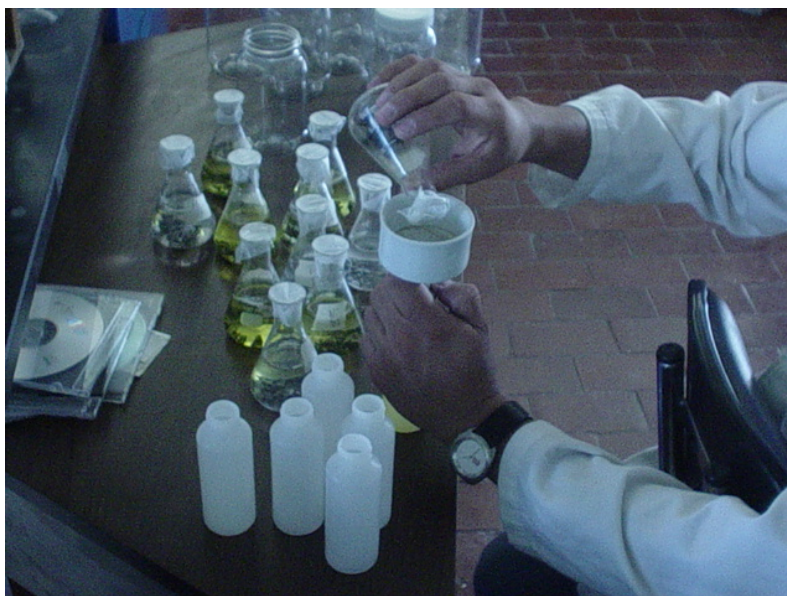
FOTOGRAFIA 49 Filtración de las muestras obtenidas por lixiviación
