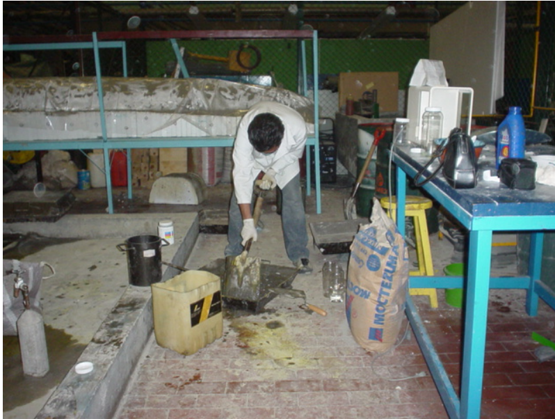
FOTOGRAFIA 3. Mezclando los componentes para concreto
