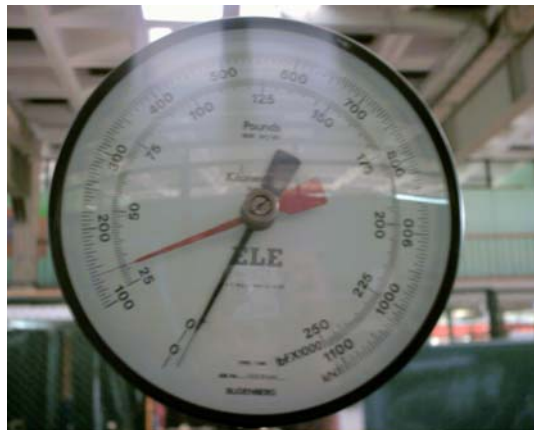
FOTOGRAFÍA 30 Indicador de Resistencia a la compresión, Pb a 5% 140
