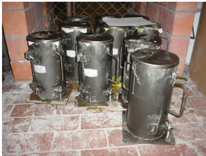
FOTOGRAFIA 6. Probetas en fraguado inicial.
