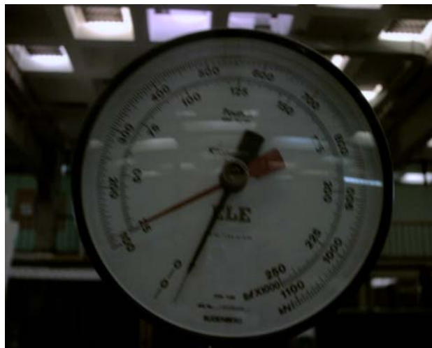
FOTOGRAFÍA 22. Indicador de Resistencia a la compresión, Ni a 5% 110 KN
