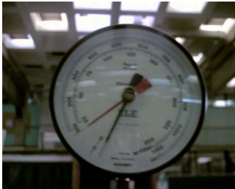
FOTOGRAFIA 12. Indicador de Resistencia a la compresión, Cr a 1% 80 KN
