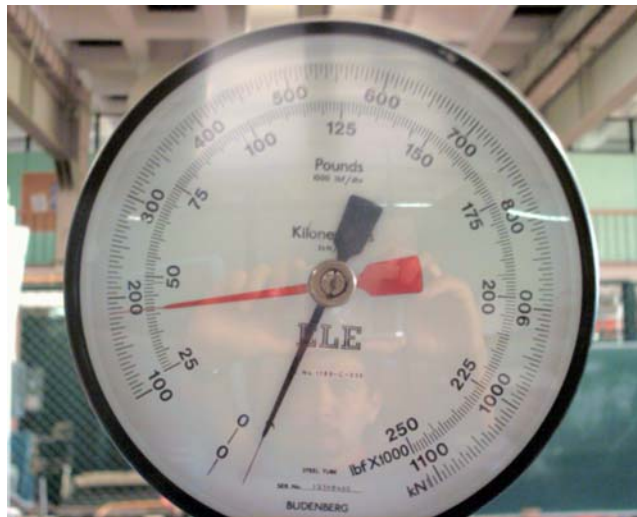
FOTOGRAFIA 25. Plomo a 1%, Resistencia a la compresión 185 KN.
