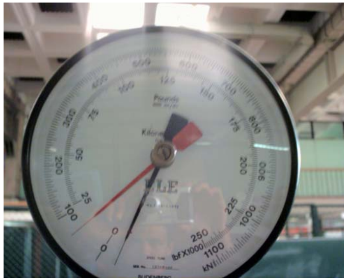
FOTOGRAFIA 14. Indicador de Resistencia a la compresión, Cr a 3% 70 KN
