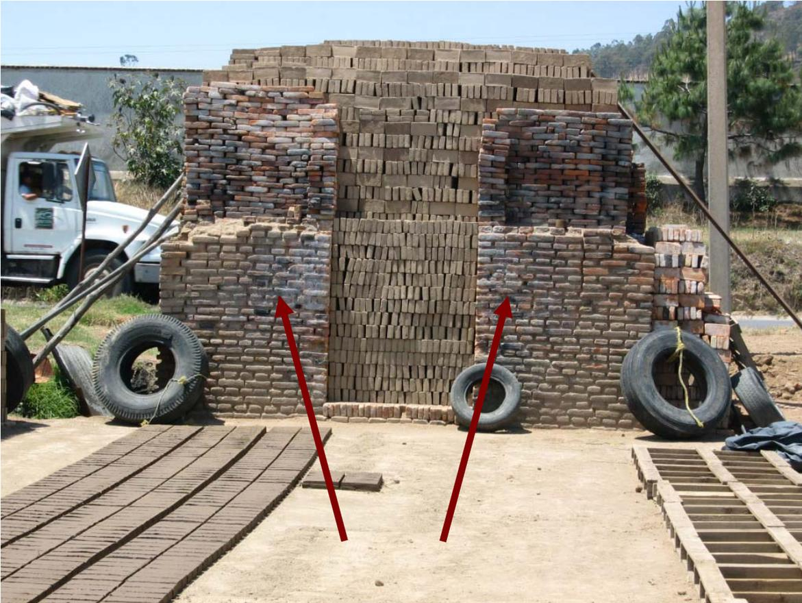
Ejemplo de horno artesanal. Señaladas en rojo están las estructuras permanentes, el resto son los ladrillos que serán horneados (nótese que estos hacen las veces de paredes y techo del horno).
