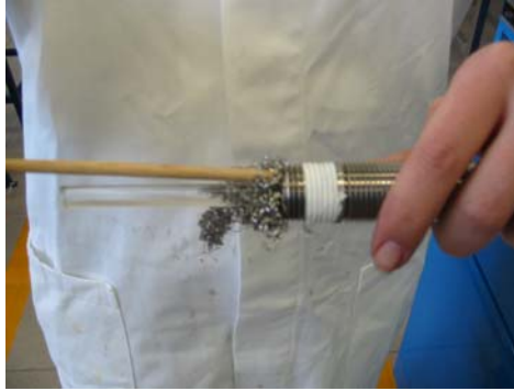
Figura 22. Proceso de empacamiento de tubo de calor
