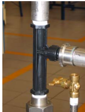
Figura 15 . Fotografía de tubo Venturi tipo Hershel
