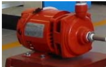
Figura 14 . Bomba centrífuga de 0.25 hp
