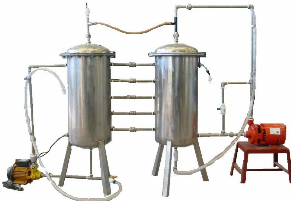
Figura 19. Evaporador a baja presión con recuperación de energía a través de tubos de calor construido en la UDLA-P
