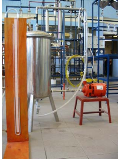
Figura 21. Medición con el manómetro de mercurio
