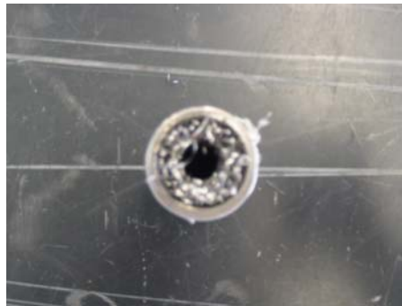
Figura 23. Interior de tubos de calor empacados con rebabas de acero inoxidable
