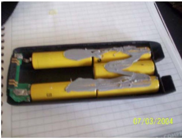
Foto 38 Pilas dentro de la Batería
