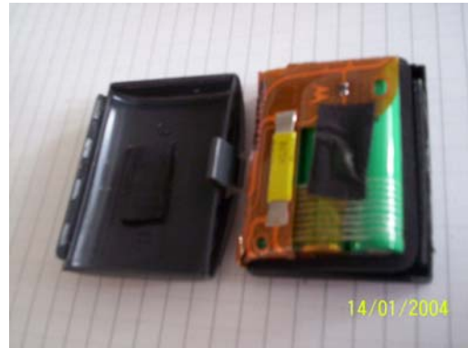
Foto 18 Pilas dentro de la batería
