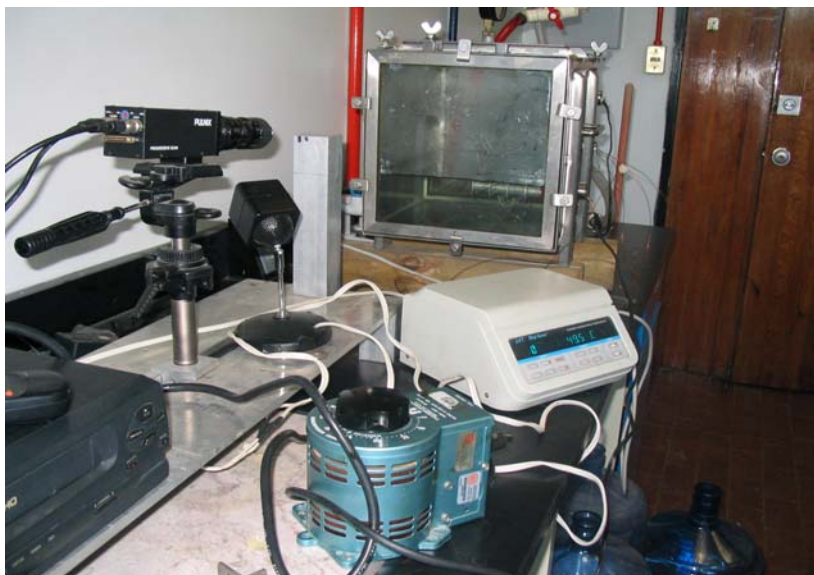
Figura.4 Dispositivo utilizado para experimentación en convección natural (cámara de acero inoxidable, reóstato, medidor de temperatura)
