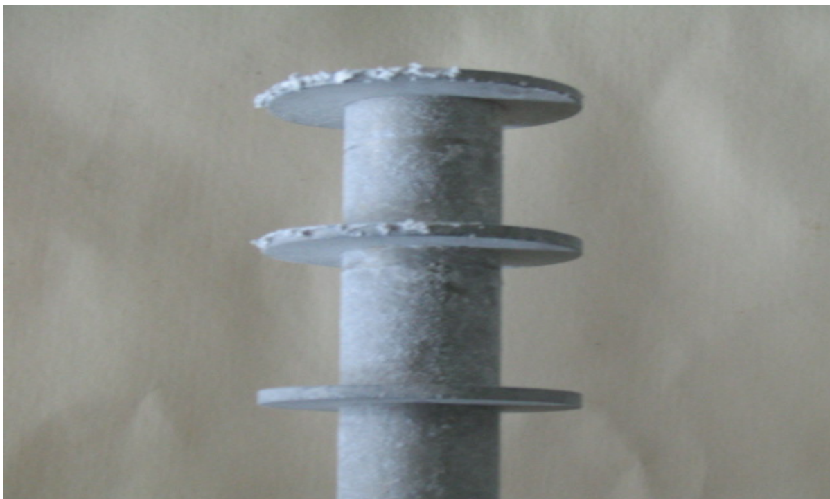
Figura 6 Incrustación en aletas con concentración de sales 52 500 ppm NaCl y 6000 ppm CaCO 3
