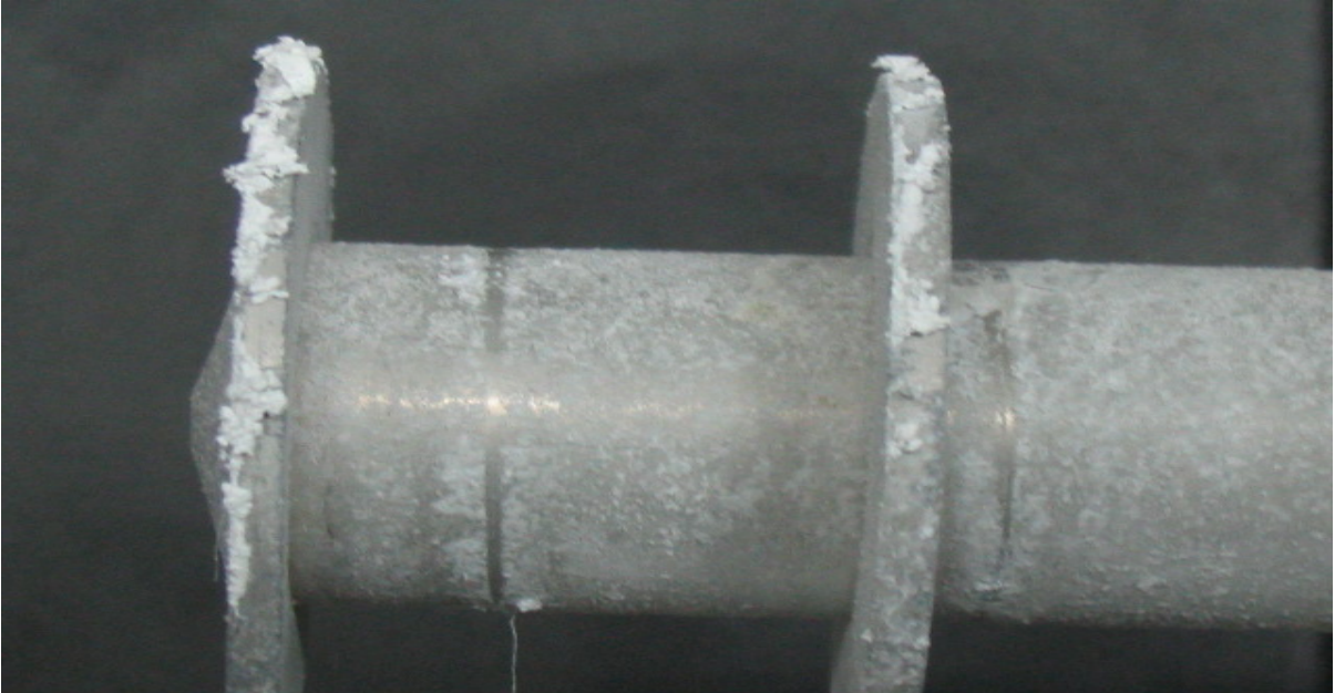
Figura 9 Incrustación en aletas con concentración de sales 52 500 ppm NaCl y 6000 ppm CaCO 3
