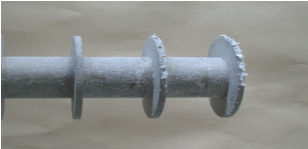
Figura 7 Incrustación en aletas con concentración de sales 52 500 ppm NaCl y 6000 ppm CaCO 3
