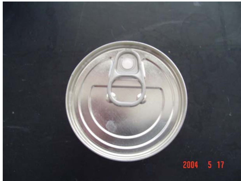
Figura. 7- Aspecto manchado de la tapa de la lata
