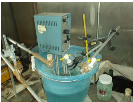
Figura 7.6. Dispositivo para control de temperaturas.
