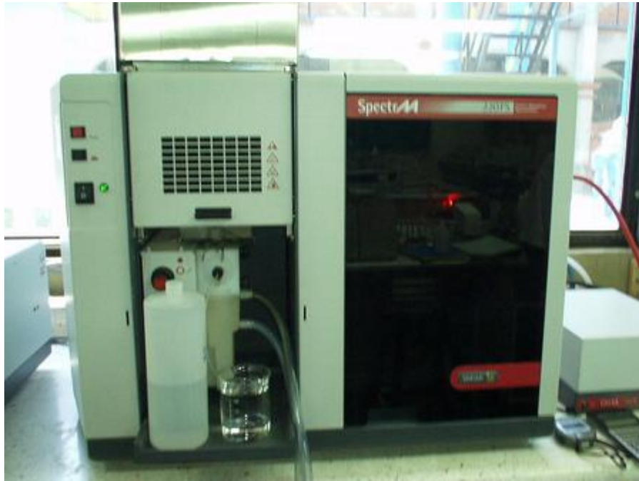
Figura 9.5. Espectrofotómetro de Absorción Atómica (Modelo Spectra 220FS) ubicado en el Laboratorio de Análisis Instrumental.
