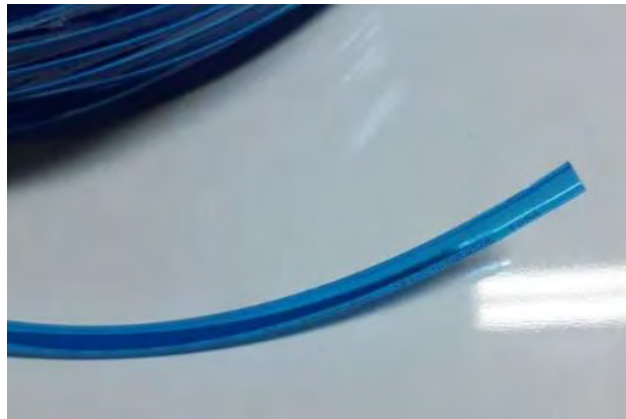
Figura 20. Manguera para aire comprimido.
