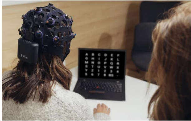
Figura 6. Ejemplo de usuario utilizando un deletreador P300 (Bitbrain, 2020)
