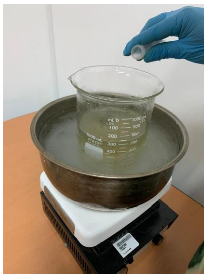
Figura 17. Incorporación del intralípido al 1% mediante una parrilla con temperatura entre 65^{\circ}\text{C} y 70^{\circ}\text{C} , y en agitación constante.
