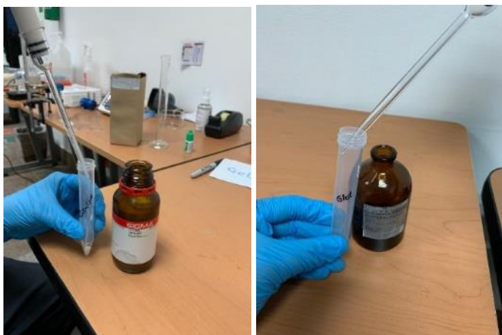
Figura 14. Preparación de soluciones de intralípido (izquierda) y glutaraldehído (derecha).
