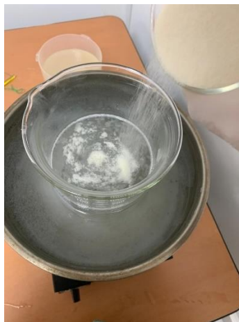
Figura 15. Preparación de gel porcina con agua destilada a 70^{\circ}\text{C}
