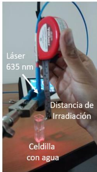
Figura 20. Arreglo experimental para la calibración del láser de 635 nm.
