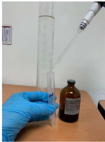
Figura 12. Dilución del Glutaraldehído al 1% en solución acuosa.
