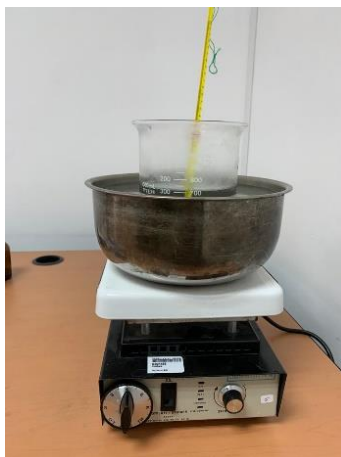
Figura 16. Agitación constante del gel porcino mediante una parrilla con temperatura de 65^{\circ}\text{C} - 70^{\circ}\text{C}
