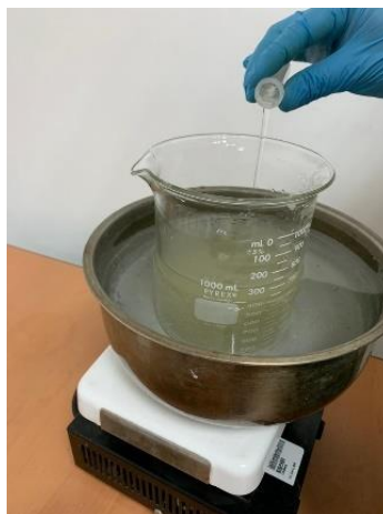
Figura 18. Incorporación del glutaraldehído al 1% mediante una parrilla con temperatura de 40°C, y en agitación vigorosa.
